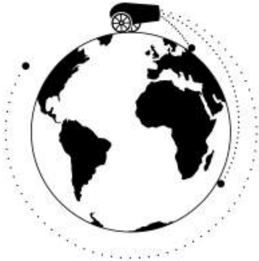
Figura 1: Uma bala de canhão disparada com diferentes velocidades à superfície da Terra. Para canhões suficientemente poderosos, a bala poderia teoricamente ficar em órbita.
