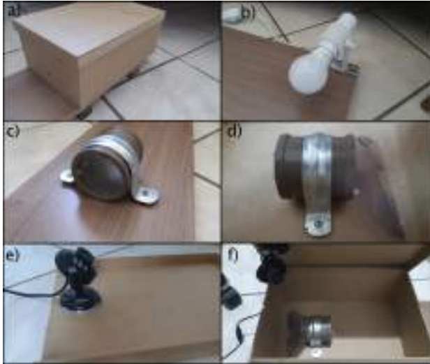
Figura 1: Itens Necessários: (a) uma caixa de MDF de (30x20x12) cm; (b) um suporte para lâmpada, para facilitar os testes; (c) uma conexão de 50 mm, para segurar as duas lentes de 2° de dioptria, fixadas na parte externa da caixa; (d) no interior da caixa utilizamos outra conexão, para segurar a lente de 6° de dioptria, e metade de um DVD atuando como a rede de difração; (e) uma webcam, para realizar a captura dos espectros; e (f) ilustra a disposição geral no interior da caixa
